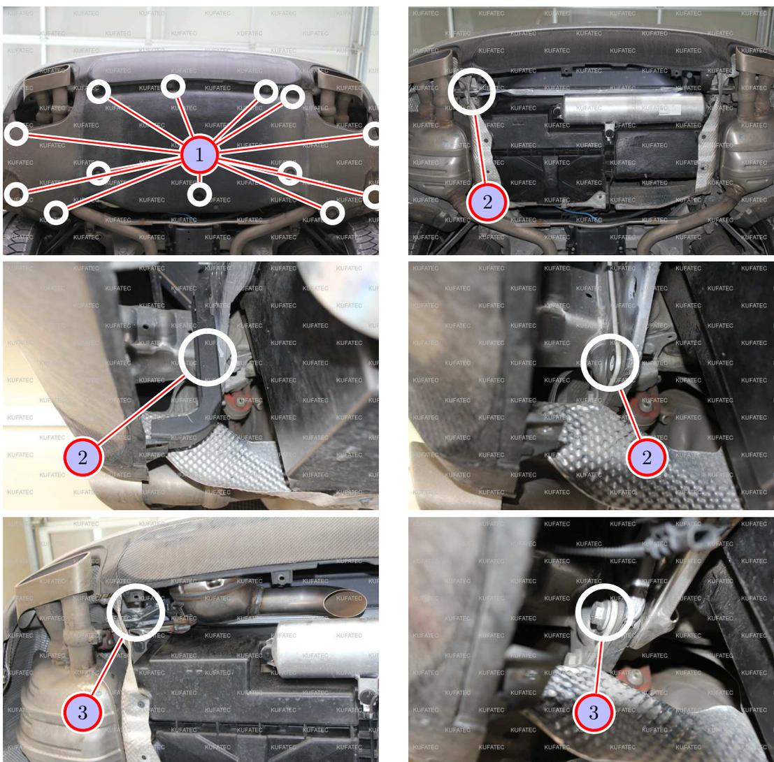
Abbildung 4: Bilder Installation externer Geräuscherzeuger
