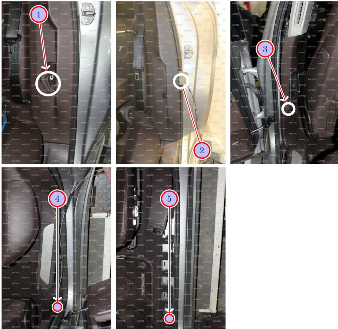
Abbildung 9: Bilder Verlegung Tasterkabel nach vorne
