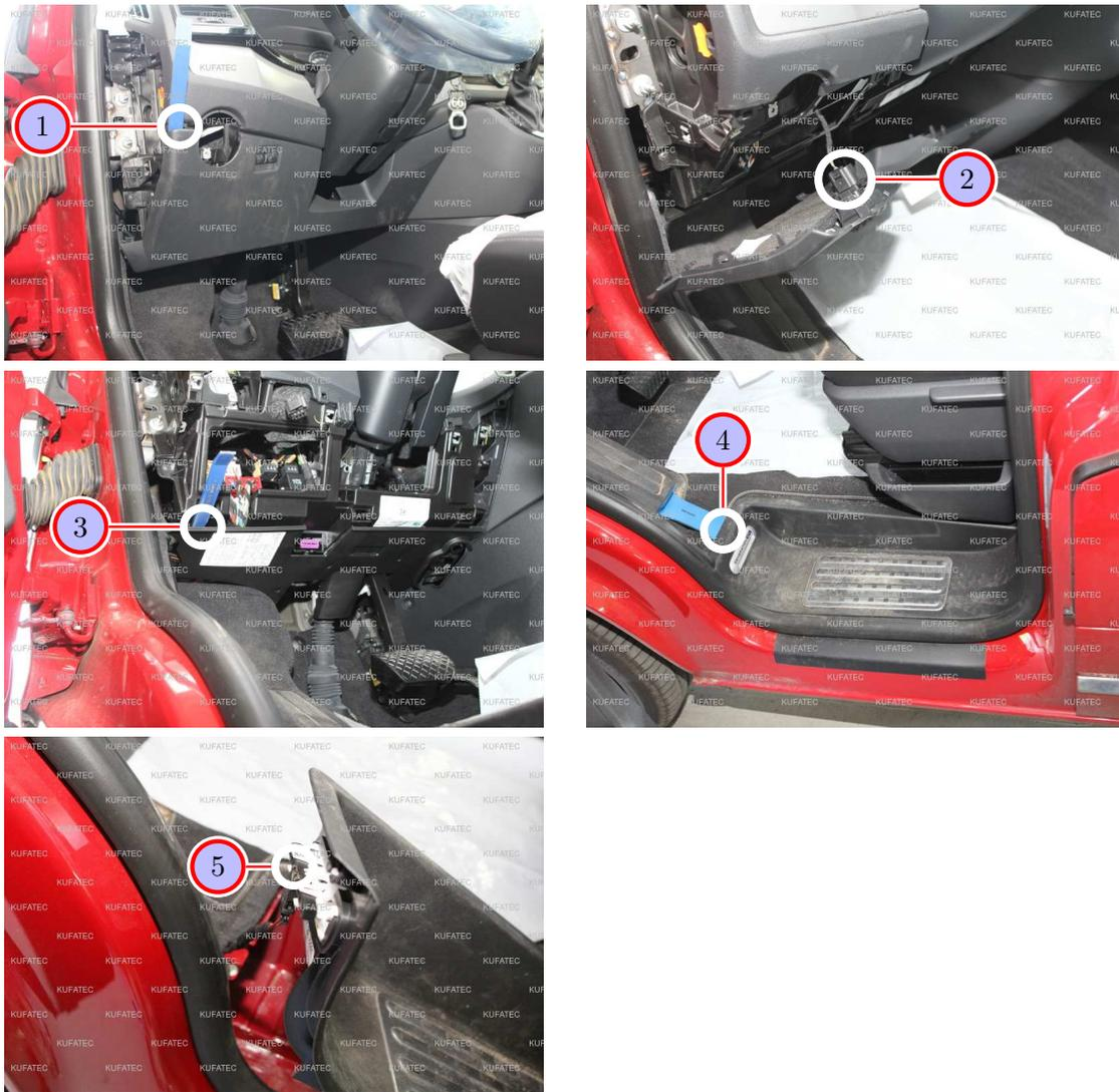
Abbildung 5: Demontage Verkleidung Fahrerseite
