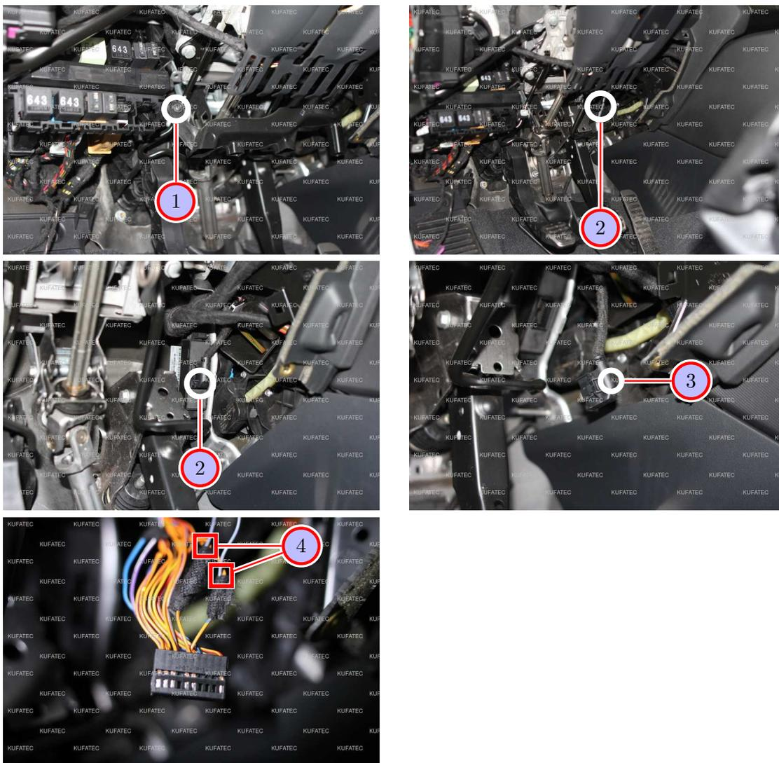
Abbildung 6: Anschluss CAN High & CAN Low
