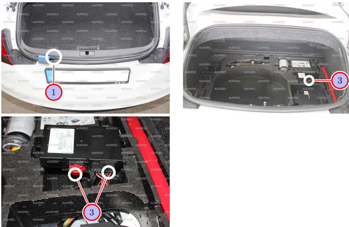
Abbildung 8: Demontage Verkleidungsteile Kofferraum
