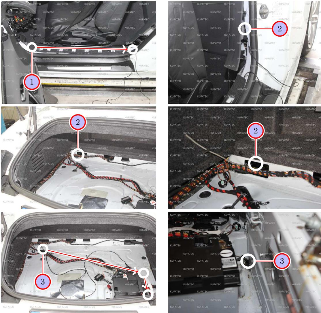
Abbildung 9: Verlegung Anschlusskabel Geräuscherzeuger
