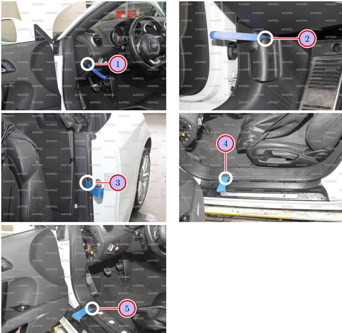
Abbildung 4: Demontage Verkleidung Fahrerseite
