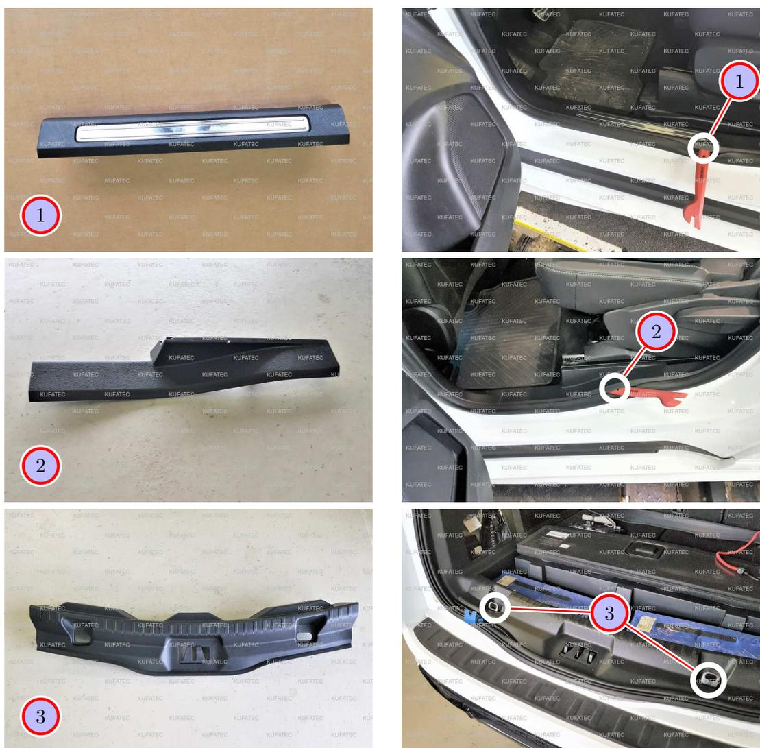
Abbildung 5: Demontage Einstiegsleisten + Kofferraumverkleidung Fahrerseite
