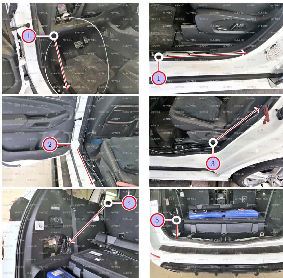
Abbildung 9: Kabelverlegung zum Geräuscherzeuger
