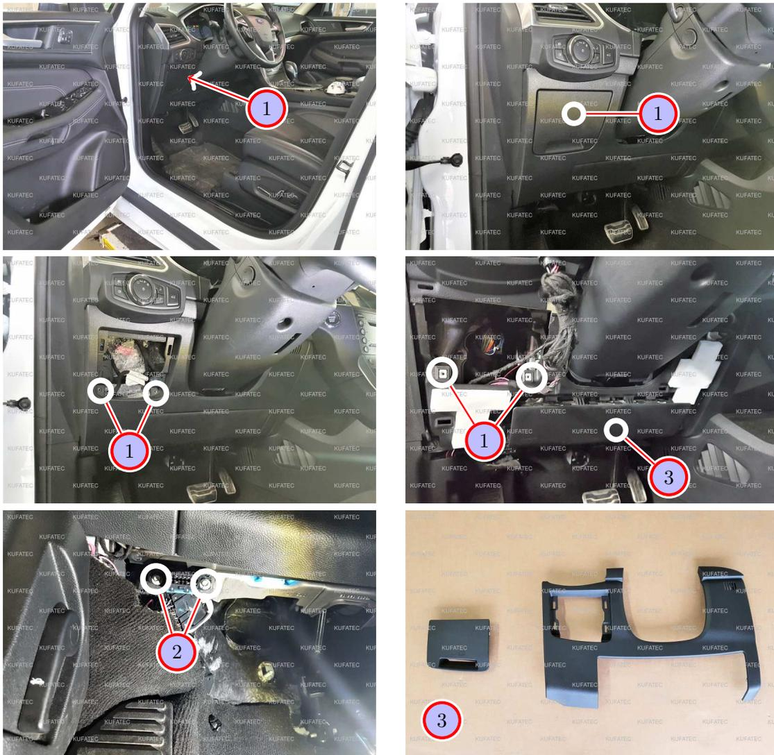
Abbildung 4: Demontage Armaturenbrettverkleidung Fahrerseite
