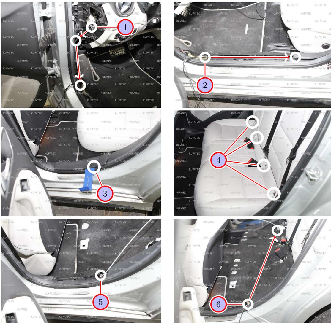
Abbildung 8: Leitungsverlegung zum Geräuscherzeuger
