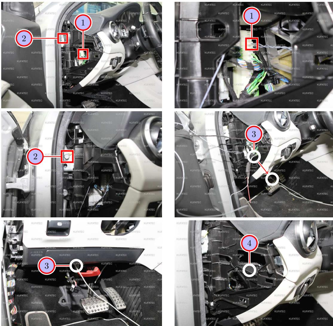
Abbildung 6: Anschluss CAN High & Low / Masse
