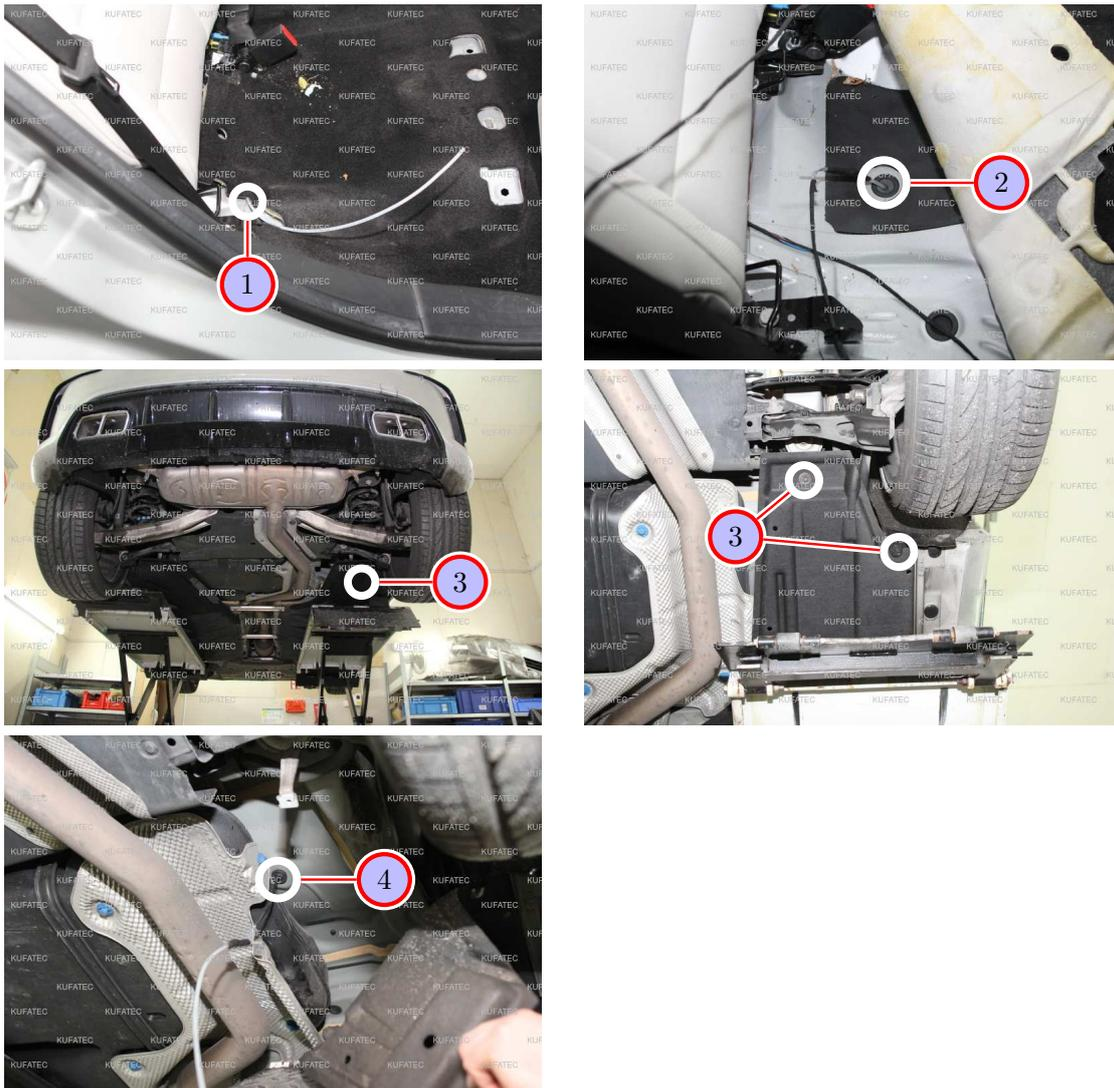
Abbildung 9: Leitungsverlegung zum Geräuscherzeuger
