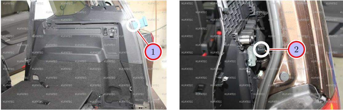
Abbildung 7: Demontage Verkleidung Kofferraum
