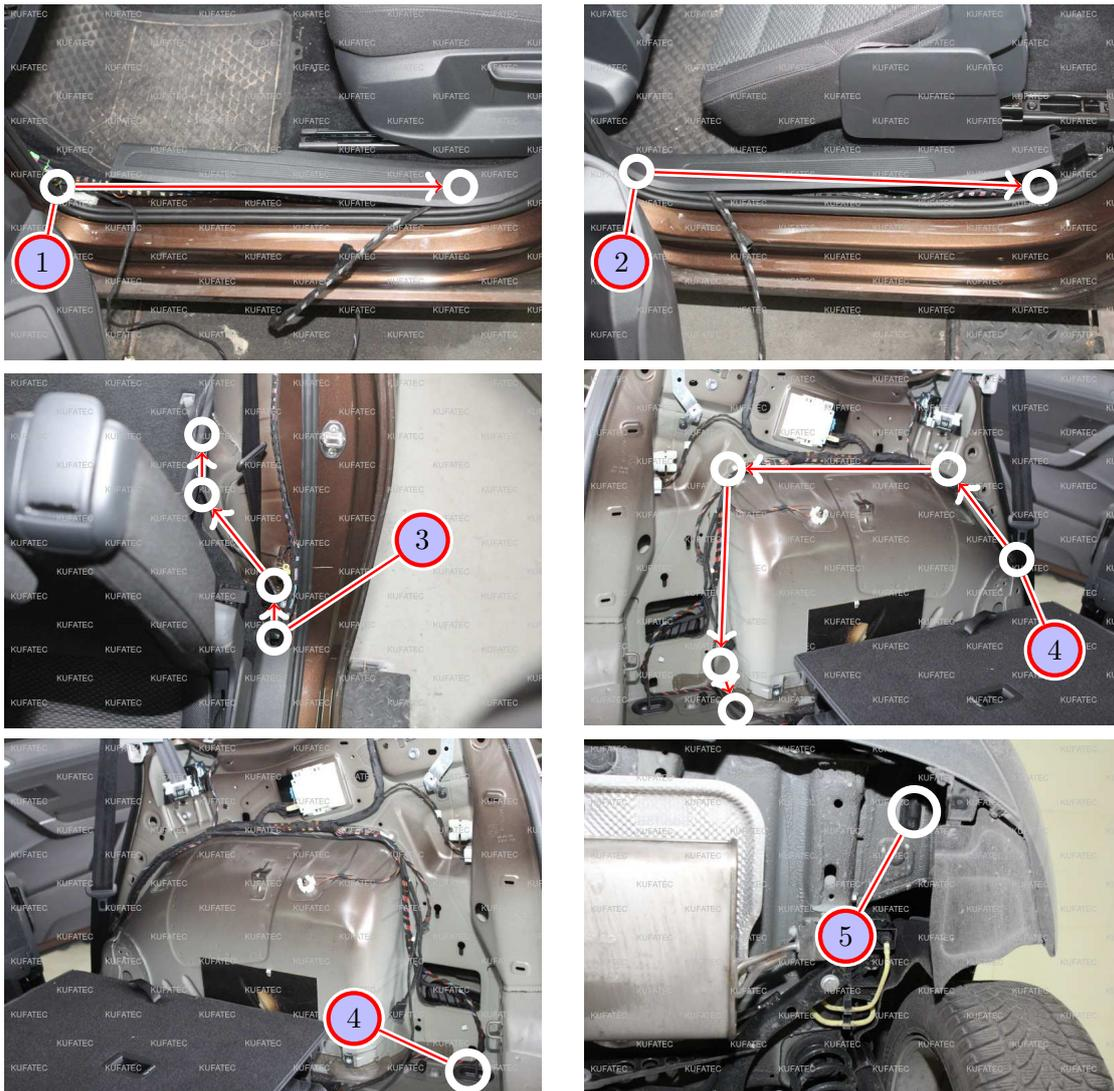
Abbildung 12: Kabelverlegung
