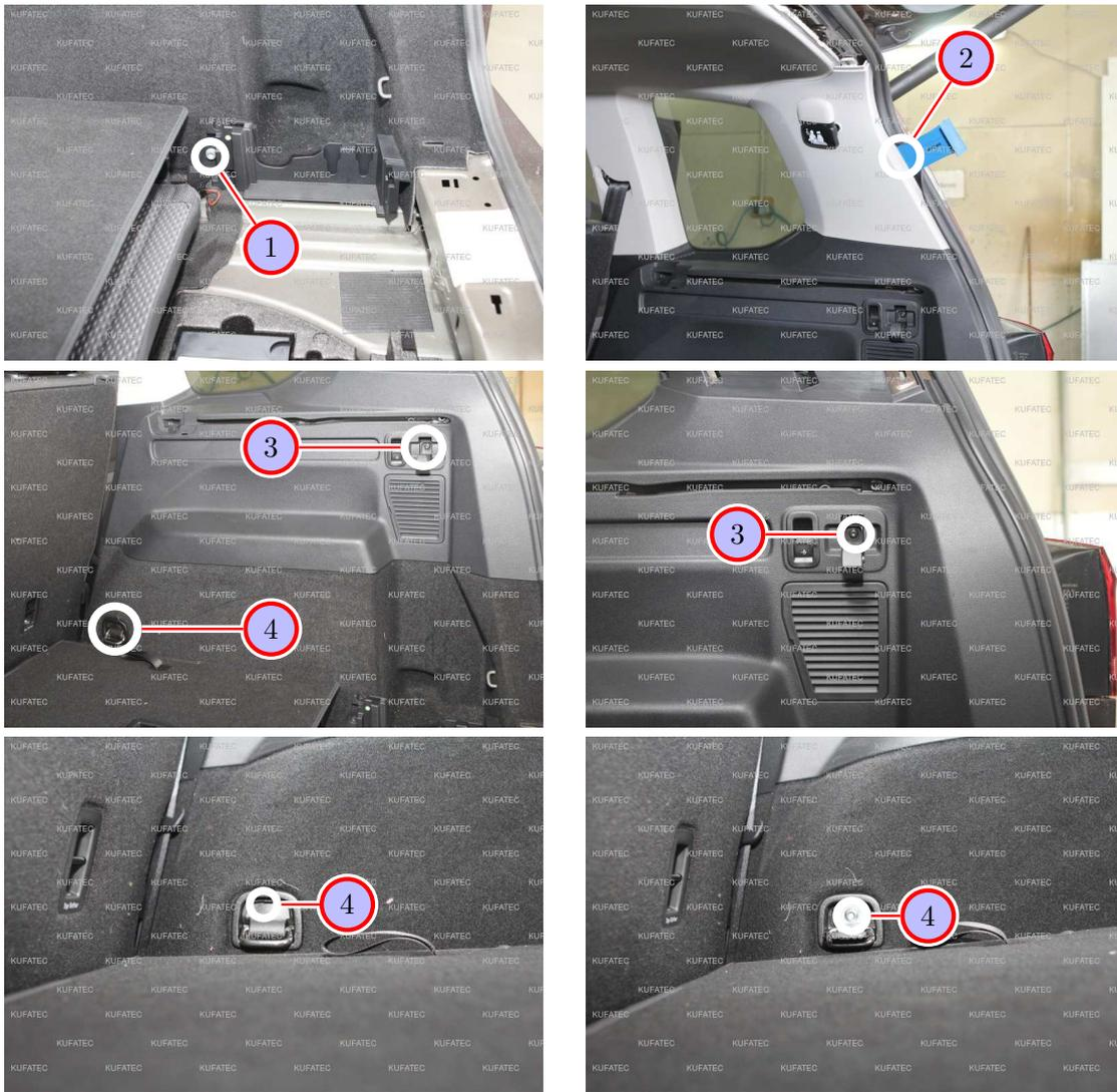
Abbildung 6: Demontage Verkleidung Kofferraum
