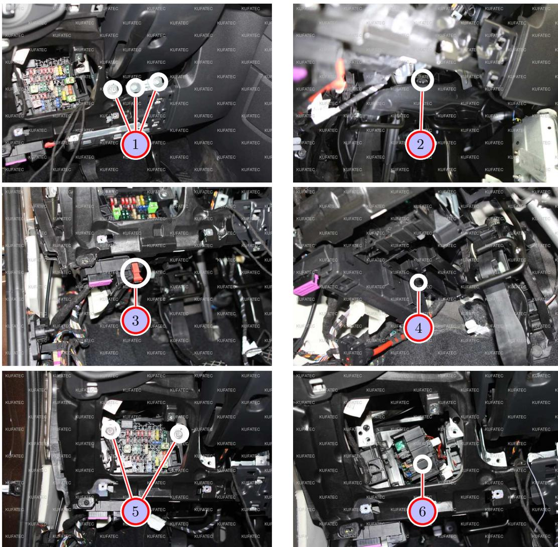
Abbildung 10: Demontage Sicherungskasten
