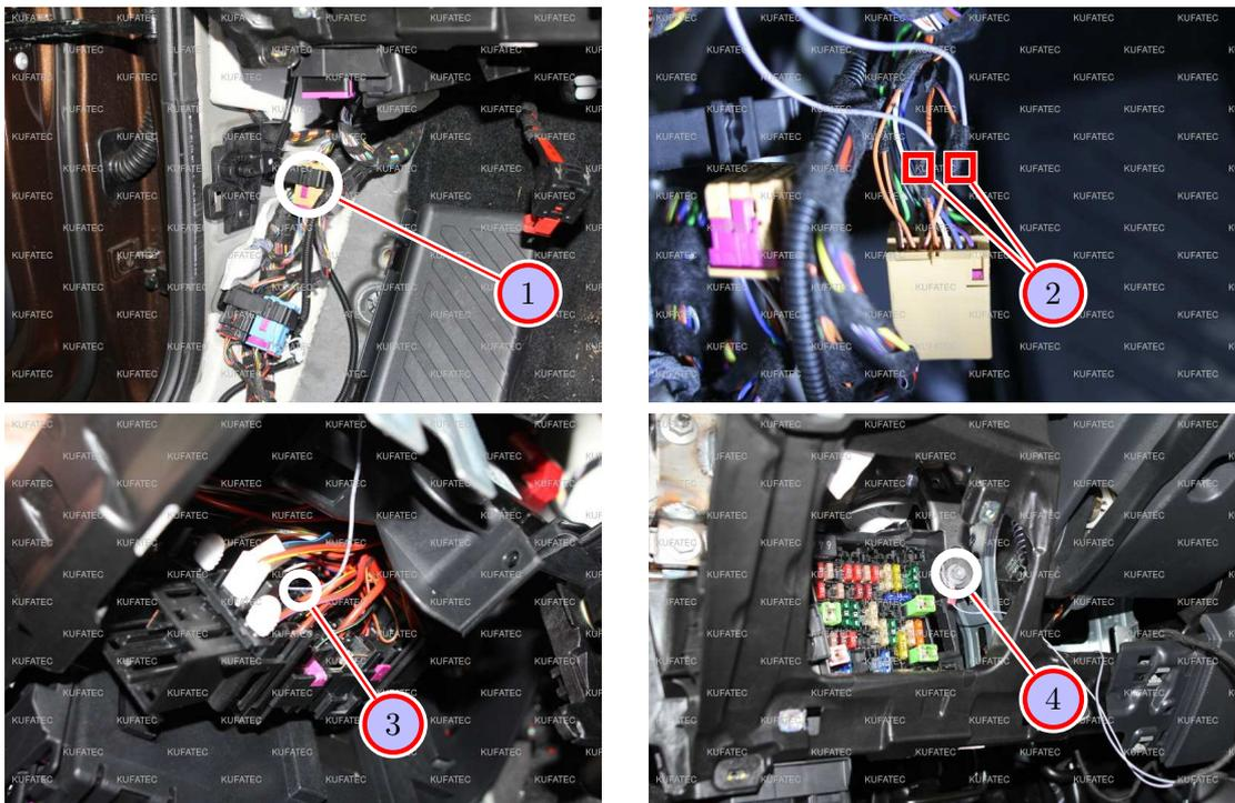
Abbildung 11: Anschluss CAN High / Low, Masse und Zündungsplus
