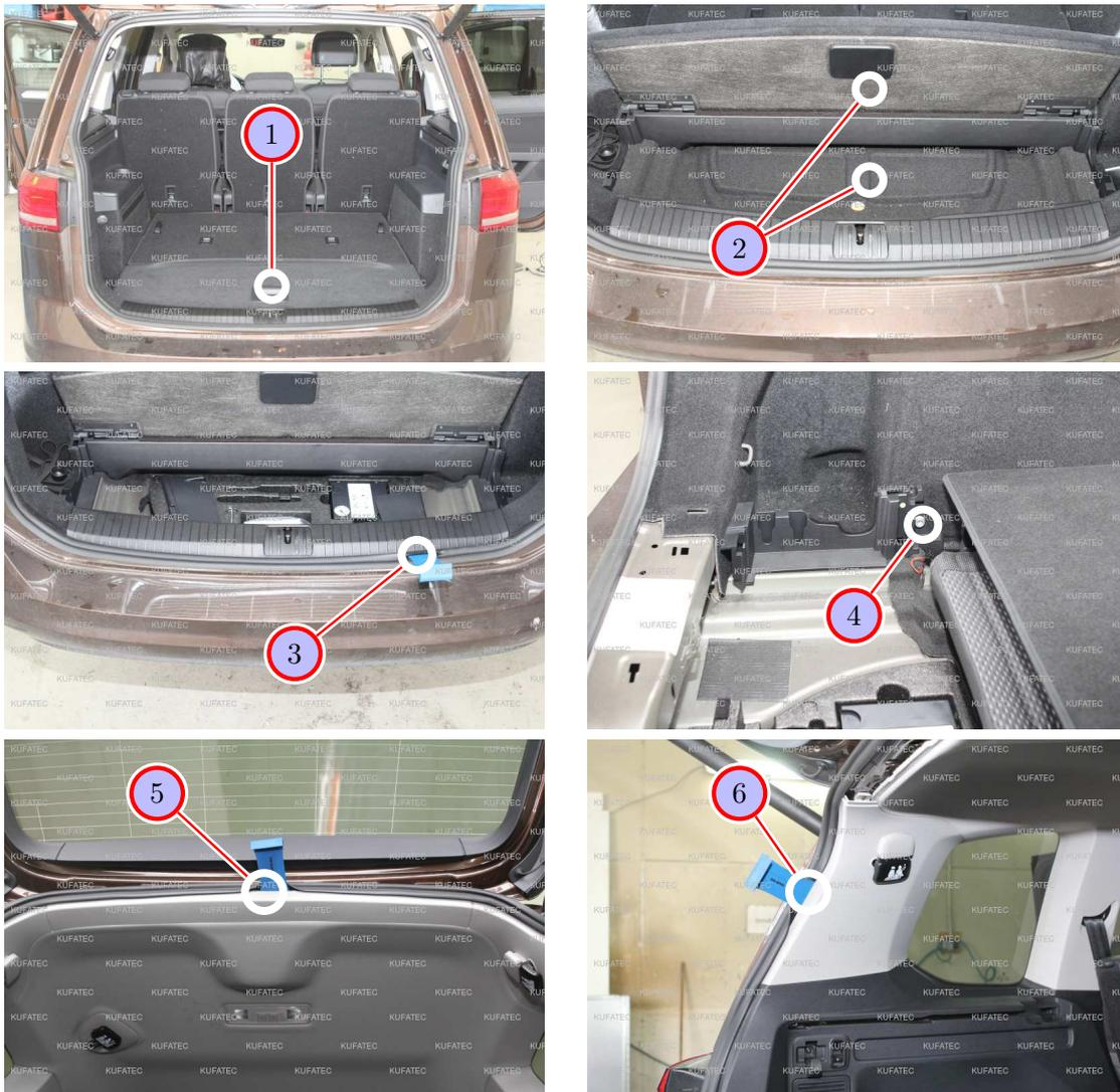
Abbildung 4: Demontage Verkleidung Kofferraum
