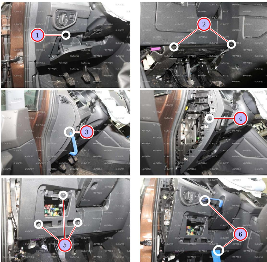
Abbildung 8: Demontage Verkleidung Fahrerseite
