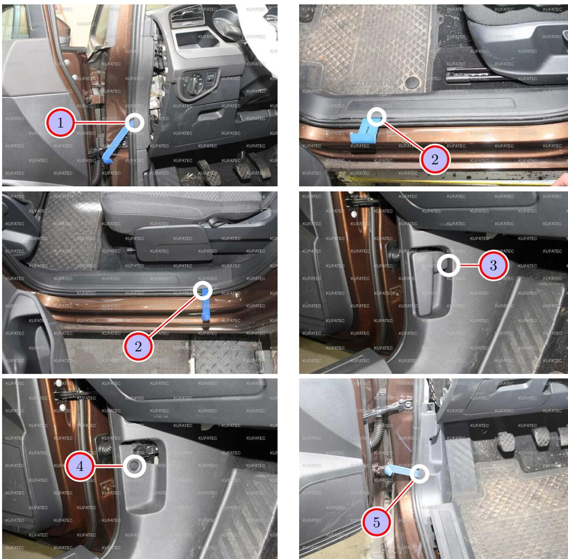
Abbildung 9: Demontage Verkleidung Fahrerseite
