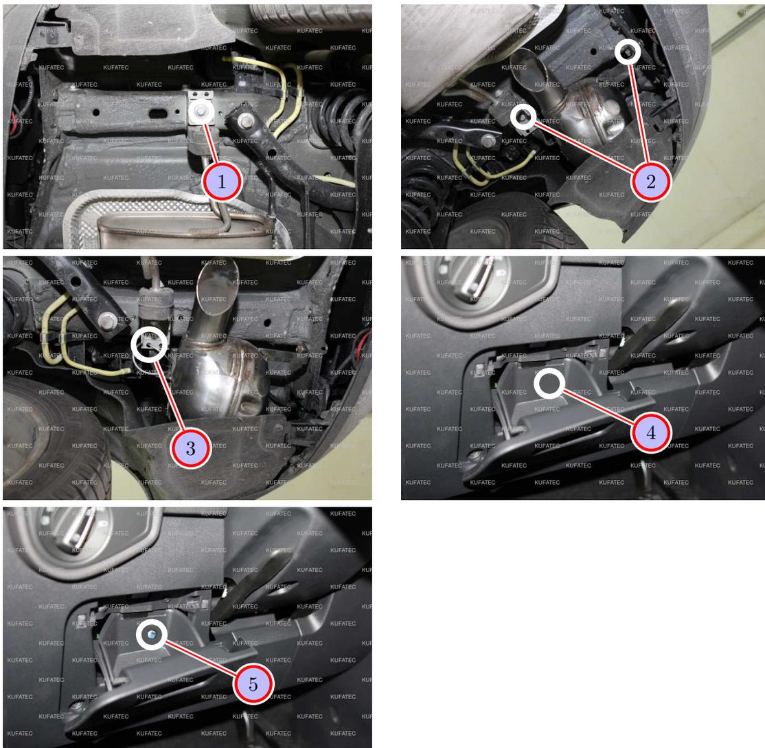
Abbildung 13: Montage Geräuscherzeuger und Taster
