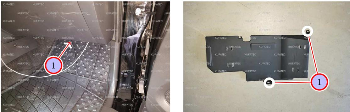
Abbildung 6: Demontage Verkleidung Beifahrerseite
