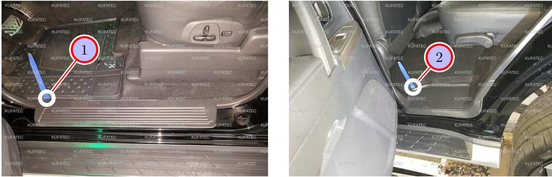
Abbildung 5: Demontage Verkleidung Fahrerseite
