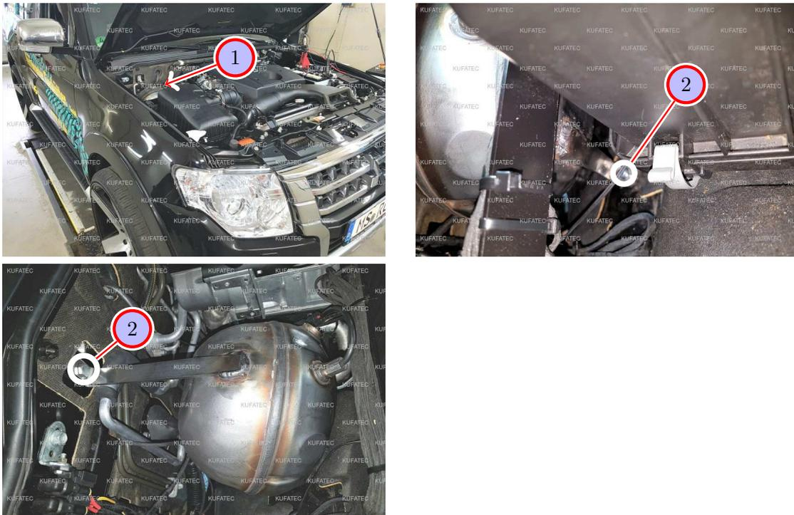
Abbildung 12: Montage vorderer Geräuscherzeuger
